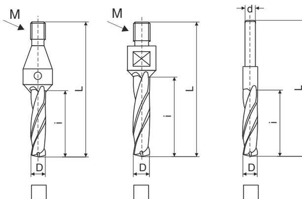
Bohrer mit Vorbohrer
